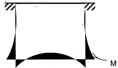
図3 作用する曲げモーメント
